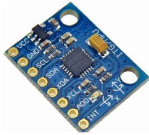
Figura 4.5: Sensor inercial para medir avance e inclinación del robot en el entorno.
