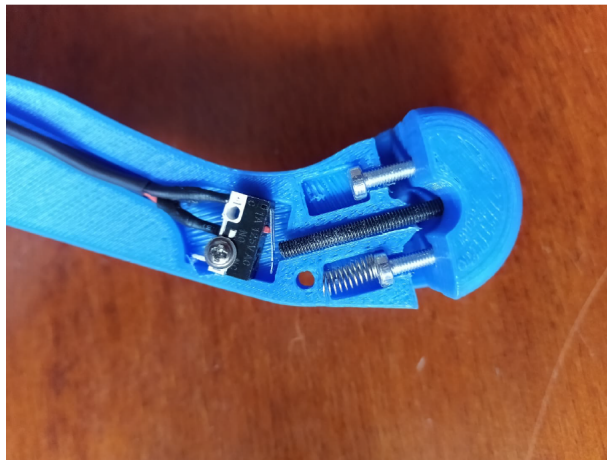
Figura 5.14: Extremidad inferior con sensor de límite de carrera.
