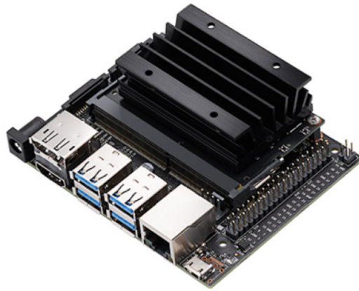
Figura 4.6: Placa integrada Jetson NANO de la familia NVIDIA.
