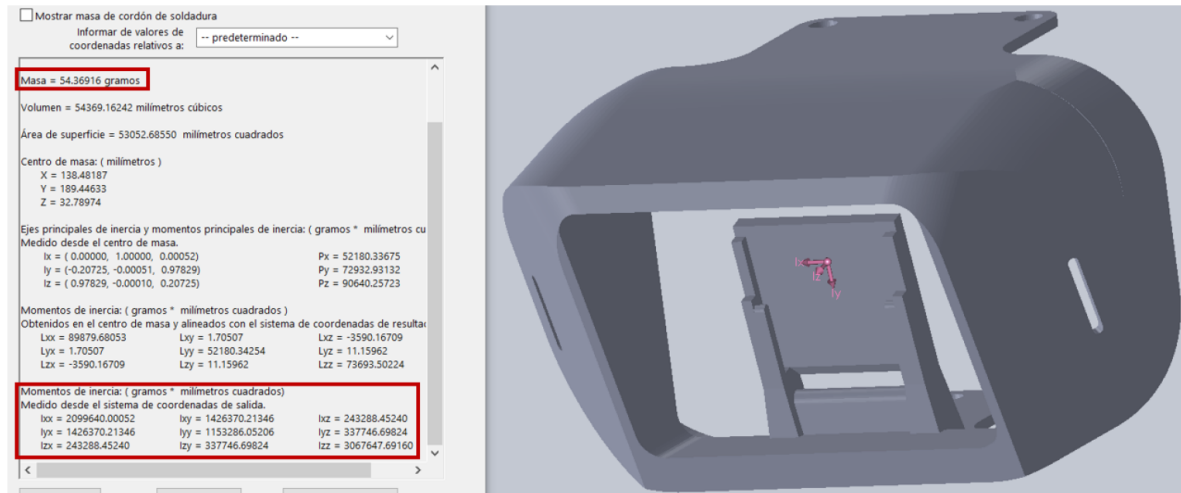
Figura 5.40: Cálculo de parámetros físicos de masa y momentos de inercia, señalados en rectángulos rojos, de cada pieza del robot.
